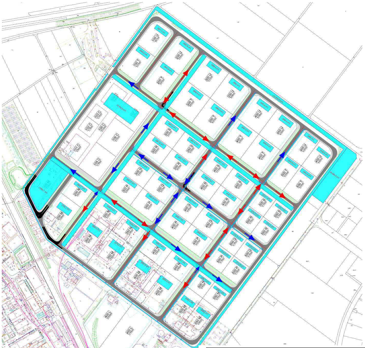
Abbildung 5: Übersicht Flächenbedarf Variante 3.2 - Versickerungsflächen sind in Cyan dargestellt, Plan als Anlage beigefügt
