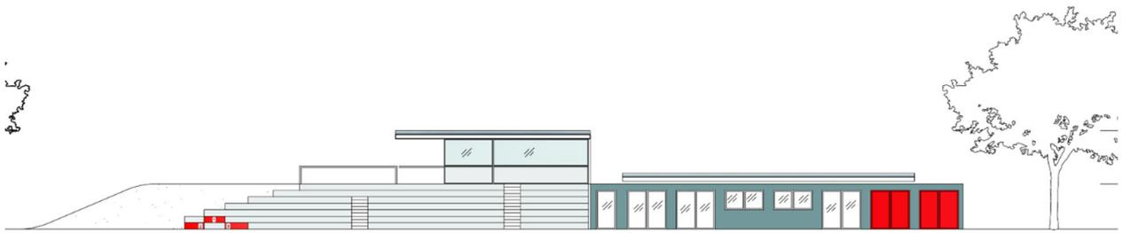
Abb. 86 Ostansicht eines in die Tribüne integrierten Gebäudes
