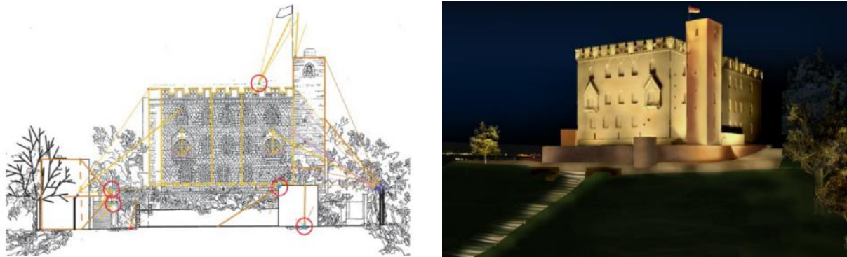
Abbildung 93: Neues Außenlichtkonzept Hambacher Schloss (2014): Mögliche Projektorenstandorte (links), Entwurfsbild mit auslaufender Beleuchtung auf der Nordseite (rechts) 200
