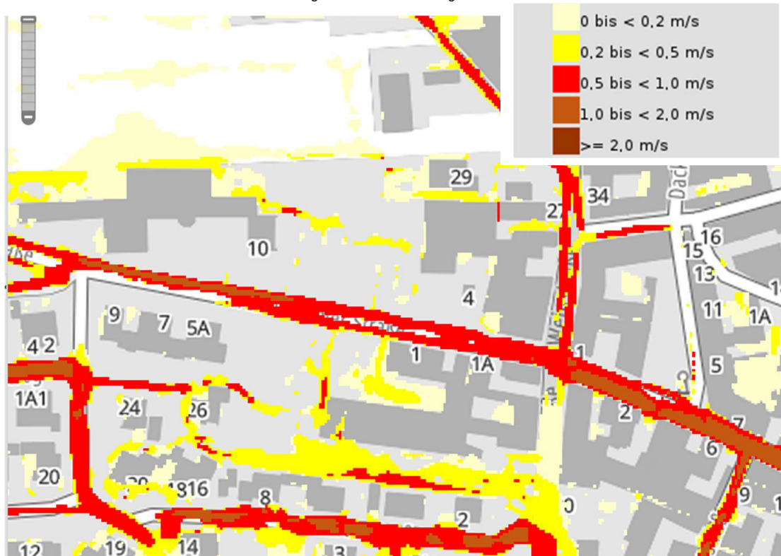
Abb. 10: Ausschnitt aus der visualisierten Überflutungssituation – Darstellung der Abflussschwindigkeit SRI7-1h /7/
