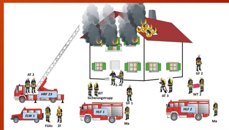
Bild 14: Typische Aufgabenverteilung für 16 Funktionen nach 15 Minuten
