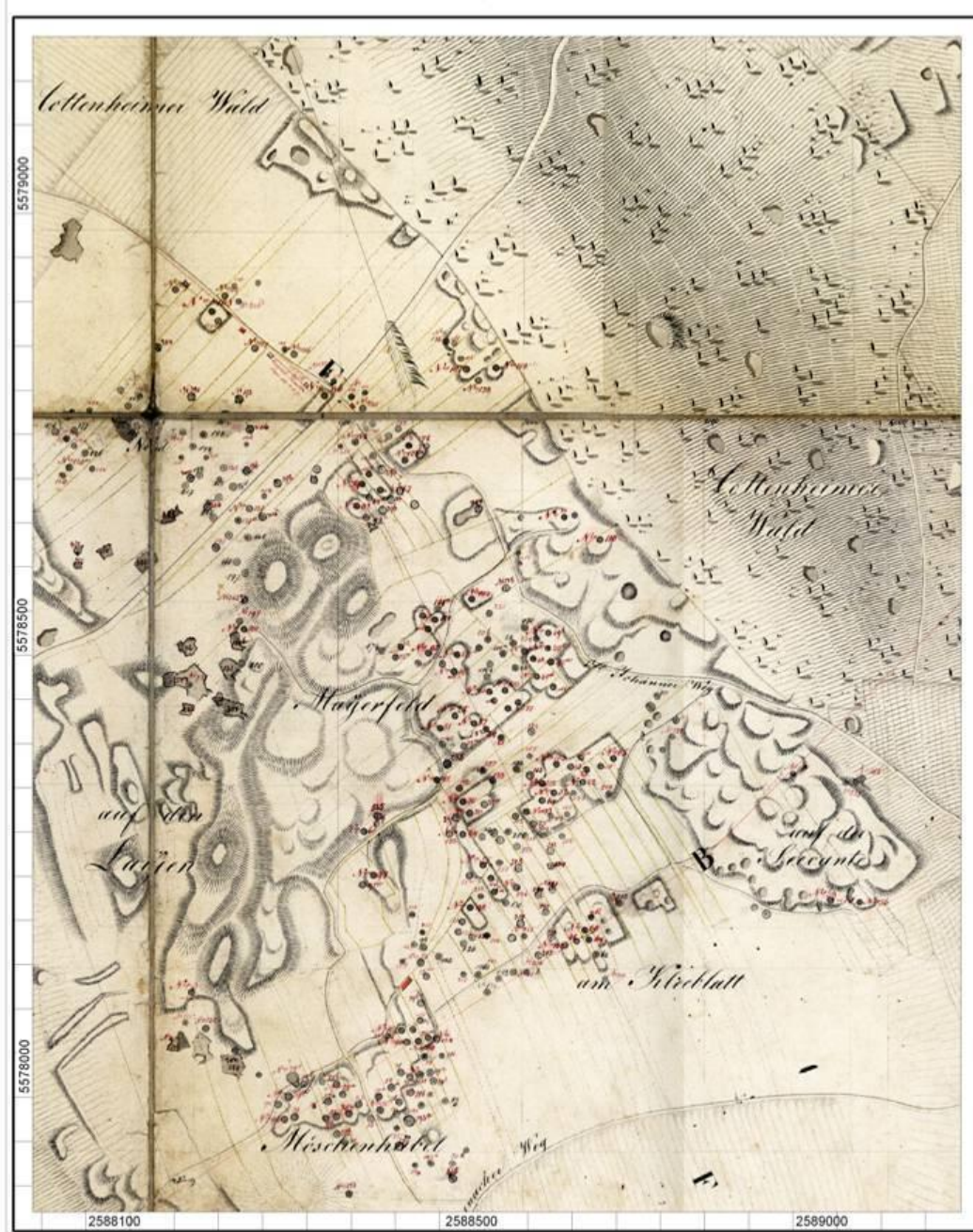
Abb. 4: Bergamtskarte von 1842-1876 für das Teilgebiet Mayener Grubenfeld. Deutlich zu erkennen ist die hohe Dichte und Konzentration der Schächte und die Lage alter Abraumphalden im Westen und Osten des Gebietes.
