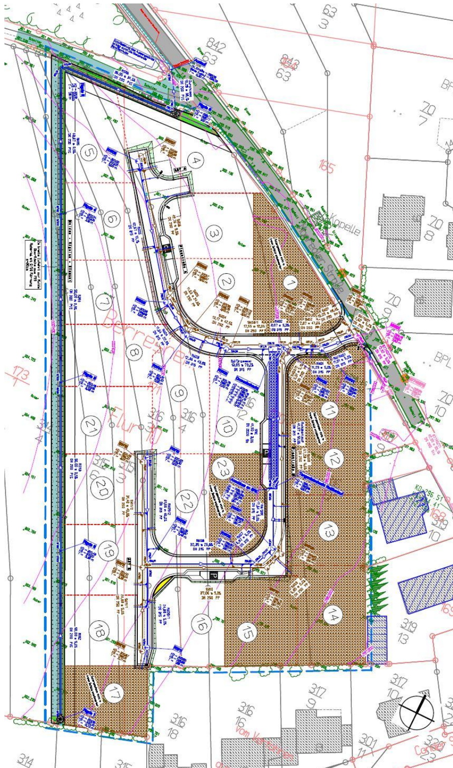
Abb.: Auszug aus der Entwurfsplanung zur Baugebietsentwässerung mit Eintragung der Leitungsverläufe im Plangebiet und Anschluss an Bestandskanal in der Monrealer Straße
