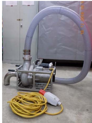
Abbildung 7: Folien, Schalttafeln Schmutzwasserpumpe
