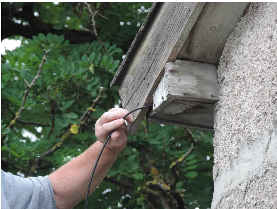
Bild 32: Um in kleinste Spalten schauen zu können wurde eine Endoskopkamera verwendet
