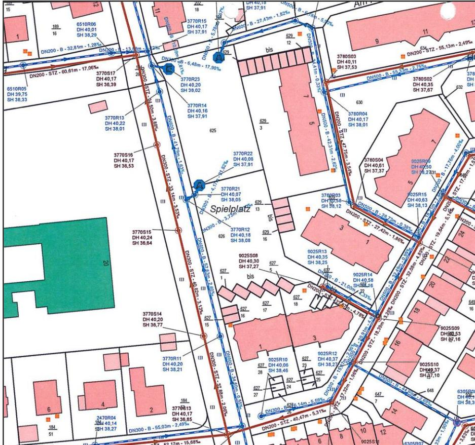
Abbildung 4: Schmutz- und Regenwasserkanäle und Anschlüsse
