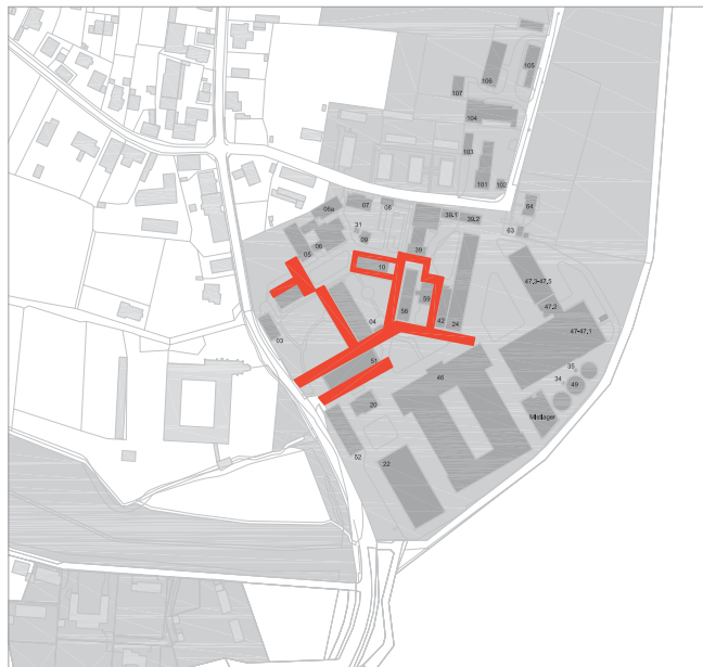
SCHEMATISCHE DARSTELLUNG DER WEGE MIT VERDICHETEN TRASSEN - ANGABEN AUS LEITUNGSPLAN SB-WL VOM 02.02.2010
