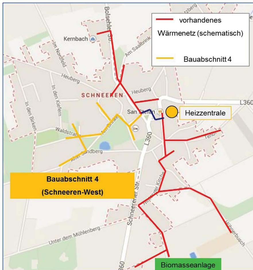
Bild 1: Nahwärmenetz Schneeren inkl. Bauabschnitt 4 (in Planung)
