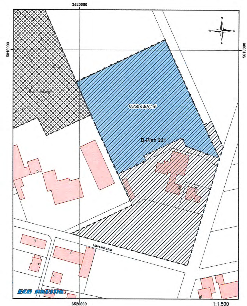
Bild 3: Plangegebene Vorbelastung im Bestand (Gewerbefläche blau markiert)
