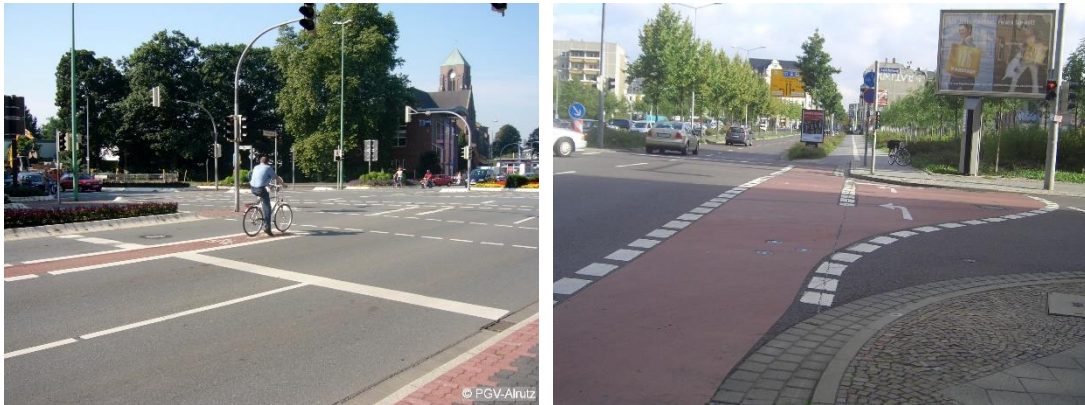
Abb. 5-22: Beispiele für direktes (links, Bocholt) und indirektes (rechts, Leipzig) Linksabbiegen
