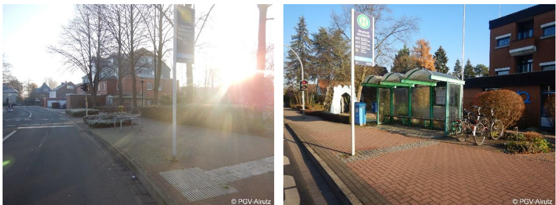
Abb. 6-12: Fahrradparksituation an Bushaltestellen: mit Rahmenhaltern (links) und Vorderradklemmen
