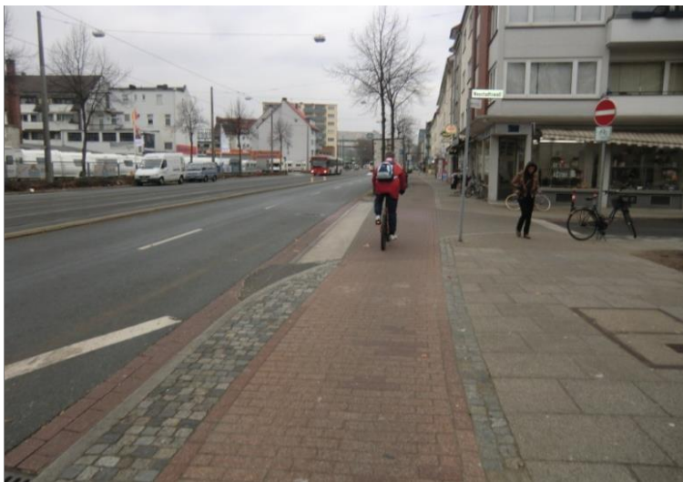
Abb. 5-17: Teilaufpflasterung im Einmündungsbereich einer Nebenstraße (Bremen)
