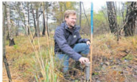
Der technische Leiter beim Projekt „Hannoversche Mooregeest“, Aaron Schaad, kontrolliert eine der 120 Grundwasserstandsstellen.
