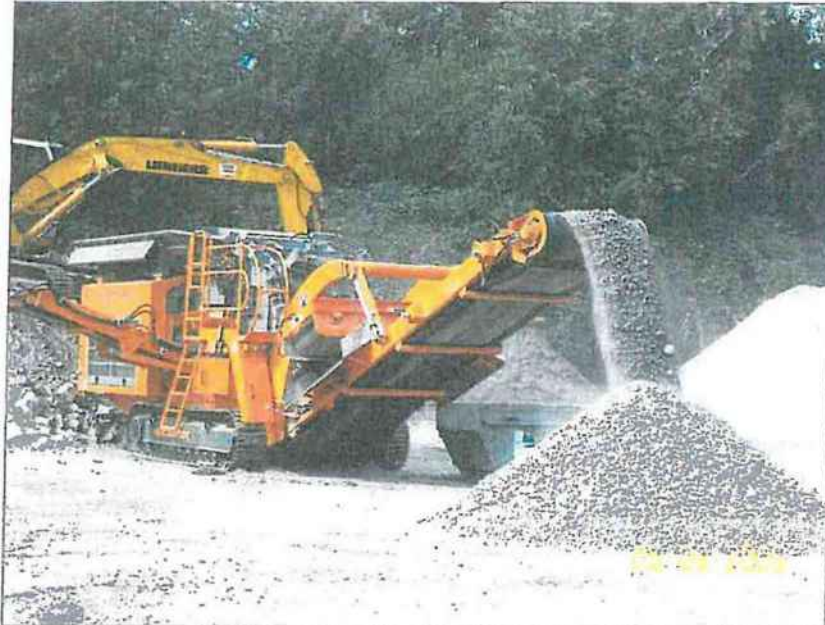
Abbildung 2 Brecheranlage Rockster R1100 (Quelle: Kormann Rockster Recycler)
