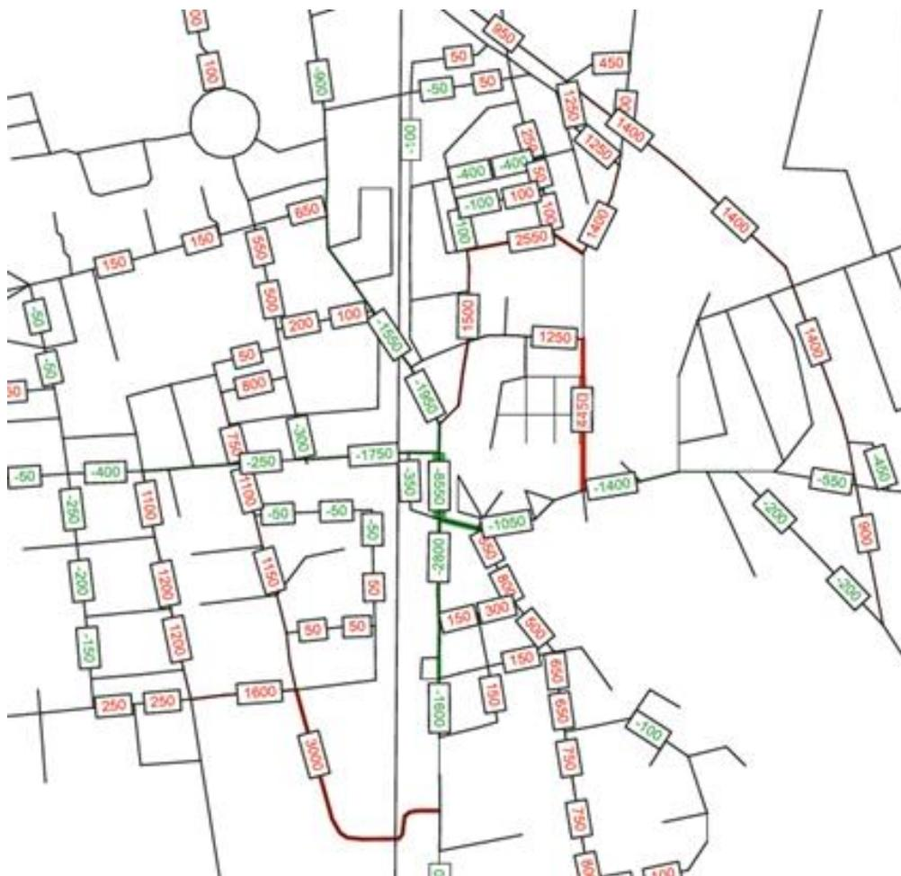
Abbildung 2: Differenzbelastung Prognosenullfall zu Prognose Einbahnstraße Versatzstück [Kfz/24h]
