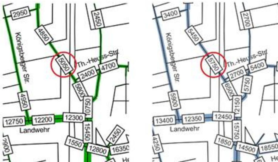
Abbildung 1: links Nullfall 2021 [Kfz/24h], rechts Prognosenullfall 2035 [Kfz/24h]
