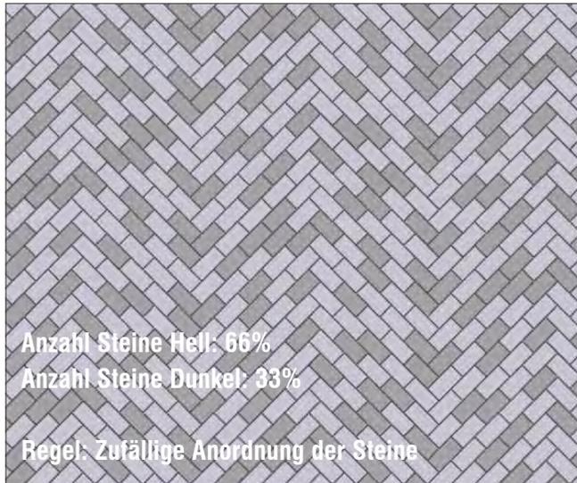
Abb. 141: Beispiel: Kleinformatiger Stein im Diagonalverband mit Naht
