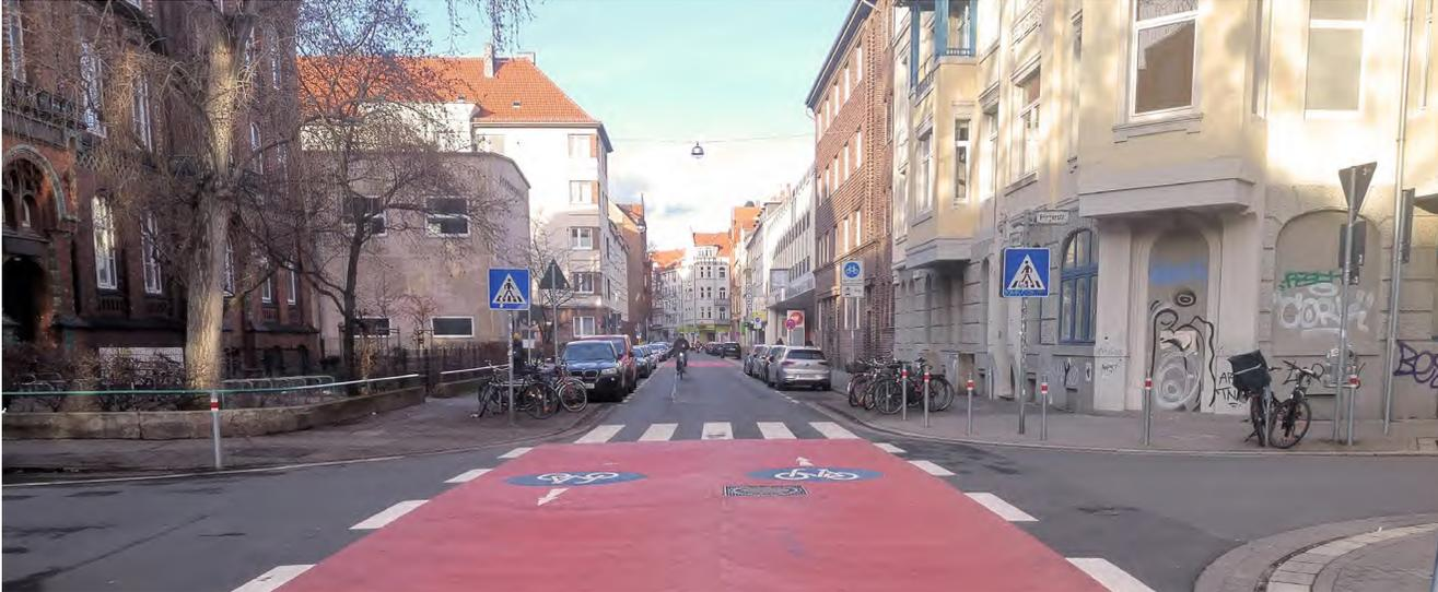
Abb. 155: Beispielbild, Fahrradstraße nimmt großflächigen Straßenraum ein und ist durch roten Anstrich hervorgehoben
