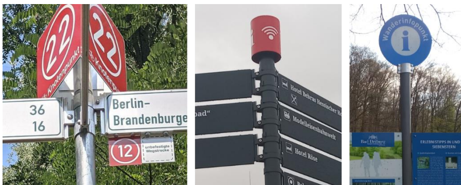
Abb. 55 Empfehlung: Montage eines rundum sichtbaren Symbols auf der Pfostenspitze einer Kompakt-Wanderinfotafel
