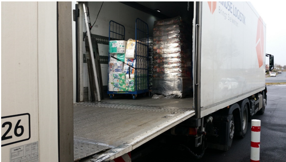
Bild 3: Entladung eines Edeka-LKW mit „Überladerfunktion“
