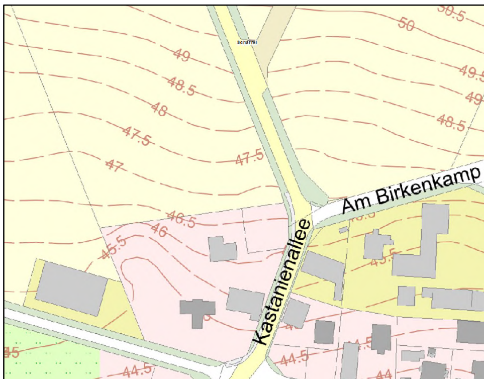
Abbildung 9: Darstellung der Höhenlinien (Quelle: Auszug aus den Geobasisdaten des LGLN, ohne Maßstab)
