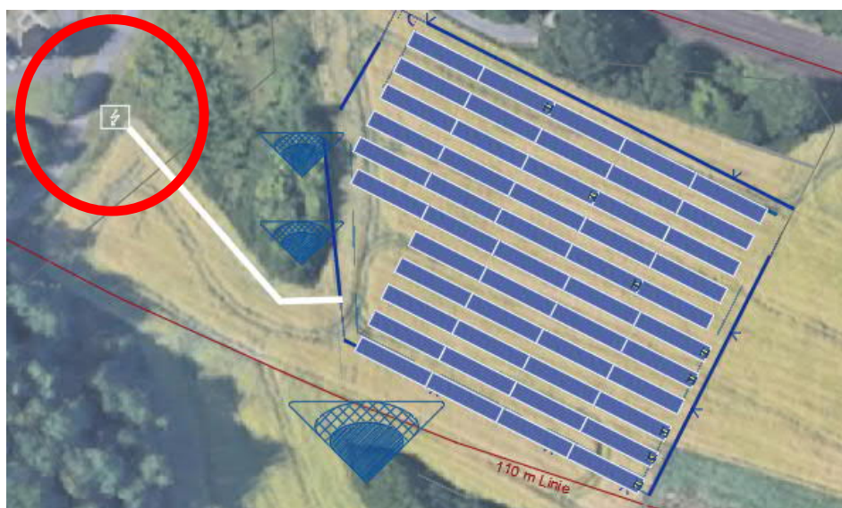
Geplanter Übergabepunkt (Trafostation) an das Mittelspannungsnetz
