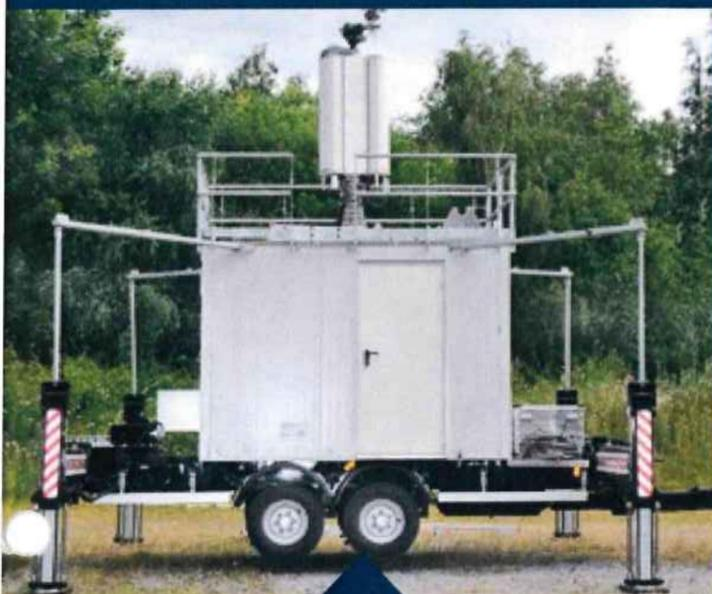
mrt20-mk1 ist die Bezeichnung für eine mobile Basisstation, welche mit einem integrierten Fahrwerk als eigenständiges Anhängersystem transportiert werden und vor Ort hydraulisch abgesetzt werden kann. Der aufgesetzte Technikcontainer bindet einen pneumatisch ausfahrbaren Aluminiummast ein. Das Gesamtsystem kann innerhalb kürzester Zeit (1-2 Stunden) aufgebaut und anschließend in ein bestehendes Mobilfunknetz integriert werden.
