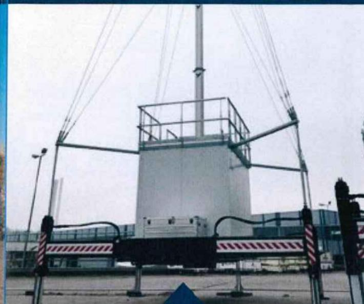
mrt20-mk4 ist die Bezeichnung für eine mobile Basisstation. Bei dem System handelt es sich im Wesentlichen um ein separat hydraulisch absetzbares Gestell mit einem Technikcontainer und einem integrierten pneumatisch ausfahrbaren Aluminiummast. Der speziell hierzu konzipierte Wechselfahrzeugträger\* zum Transport des mrt20-mk4 kann mit einem herkömmlichen LKW mit Ringmaulkupplung und Druckluftbremsanlage gezogen werden.
