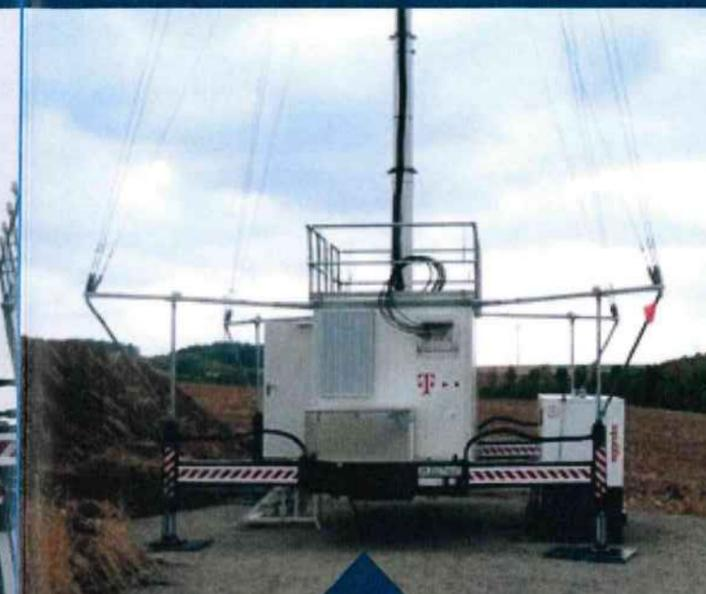
mrt25-mk5 ist die Bezeichnung für eine mobile Basisstation. Bei dem System handelt es sich im Wesentlichen um ein separat hydraulisch absetzbares Gestell mit einem Technikcontainer und einem integrierten pneumatisch ausfahrbaren Aluminiummast. Der speziell hierzu konzipierte Wechselfahrzeugträger\* zum Transport des mrt20-mk5 kann mit einem herkömmlichen LKW mit Ringmaulkupplung und Druckluftbremsanlage gezogen werden.
