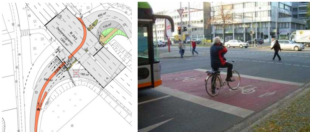
Abbildung 69 – Beispiel für direktes Linksabbiegen für Radfahrende in Hildesheim (links) und aufgeweiteter Radaufstellstreifen in Hannover (rechts)
