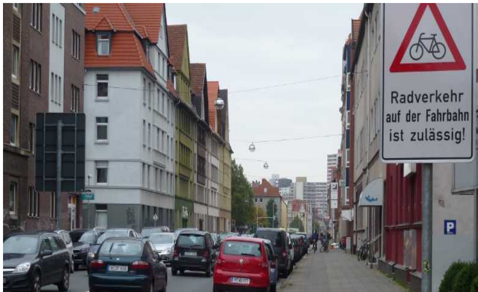
Abbildung 66 – Kennzeichnung bei Aufhebung der Radwegebenutzungspflicht eines getrennten Geh- und Radweges
