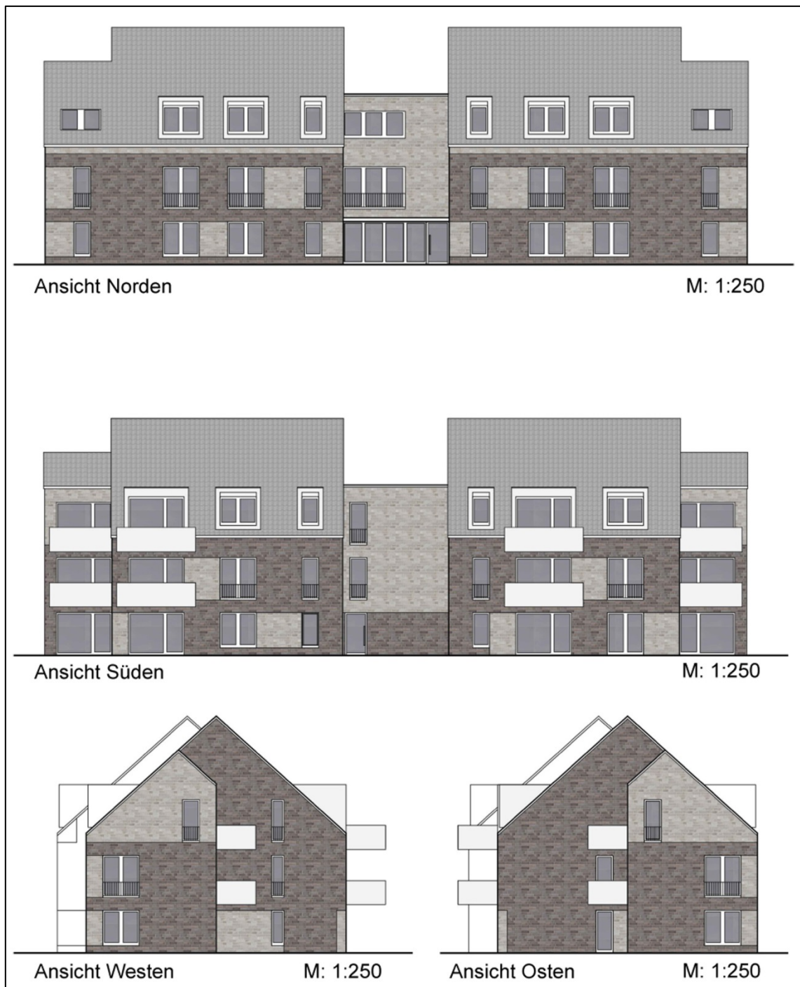
Abbildung 7: Ansichten Gebäudetyp „12 Wohneinheiten“ (Architekten Spiekermann)
