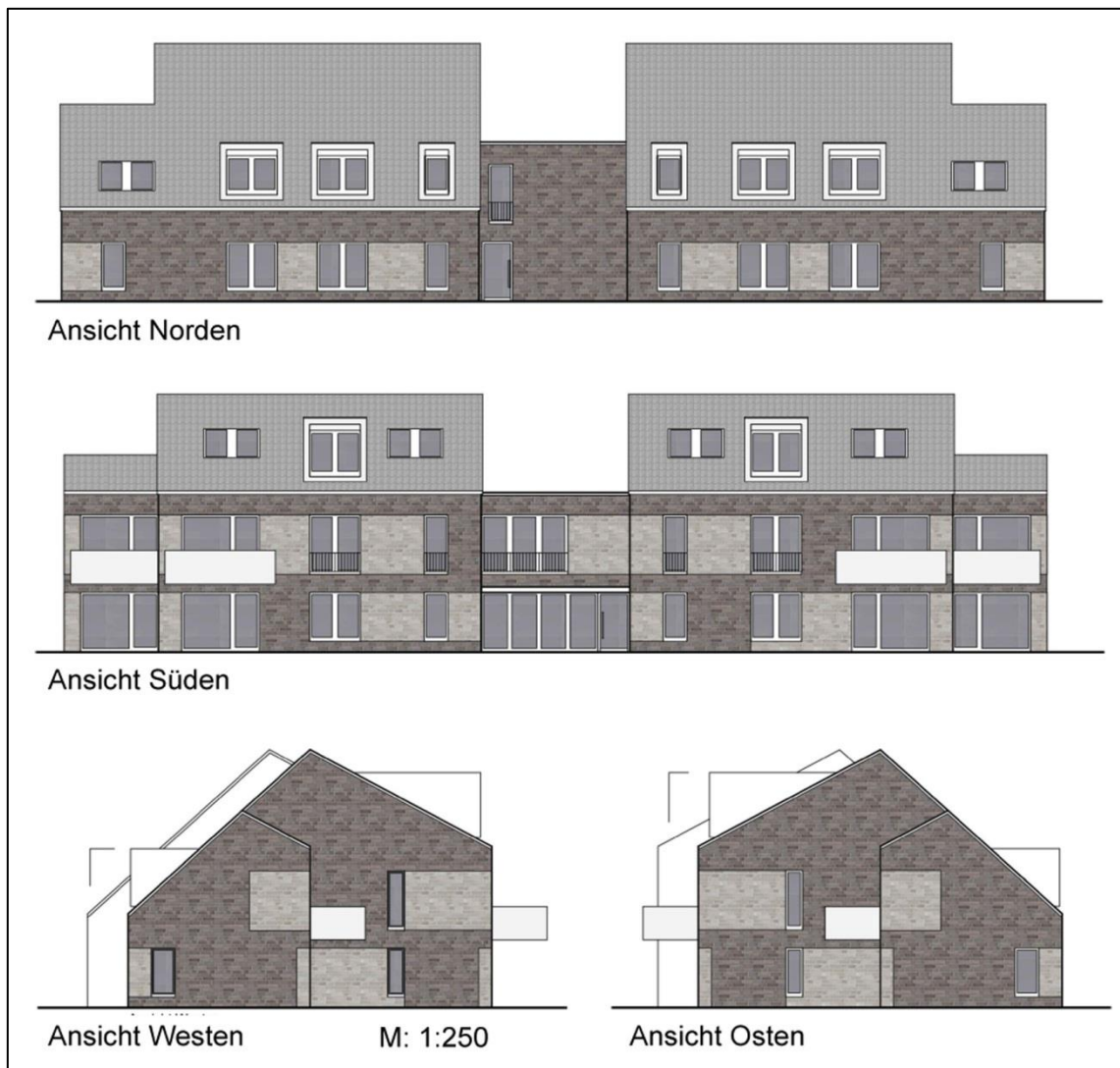
Abbildung 6: Ansichten Gebäudetyp „8 Wohneinheiten“ (Architekten Spiekermann)
