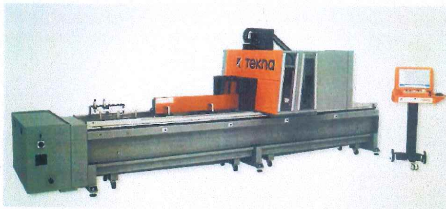
4-Achs-Stub Bearbeitungszentrum Tekna 427 Magnum des Herstellers Tekna:
