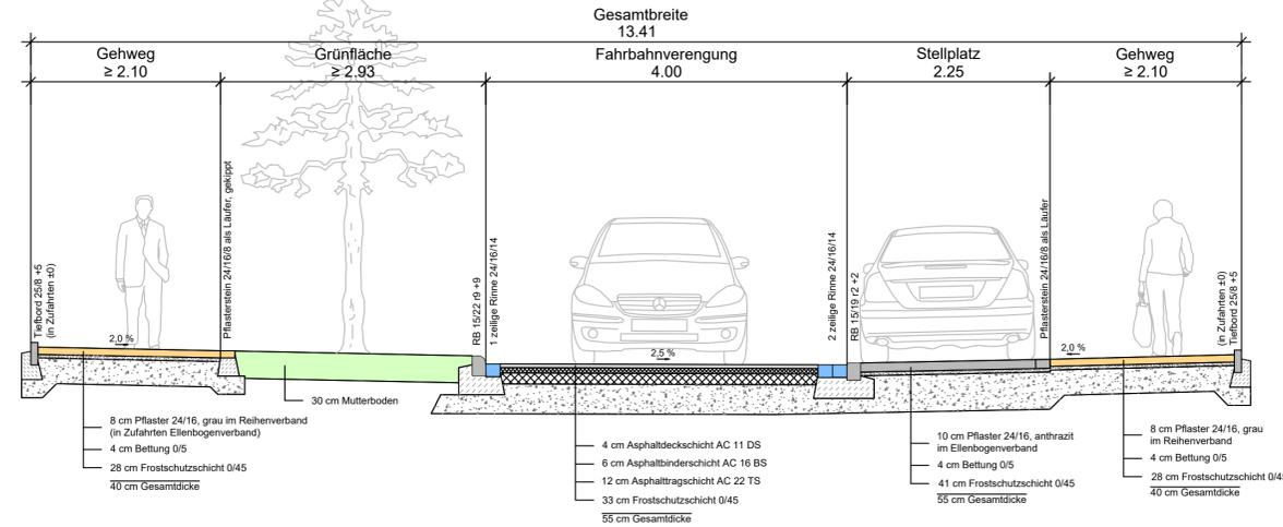
Deckenaufbau Fahrbahn M. 1:10
