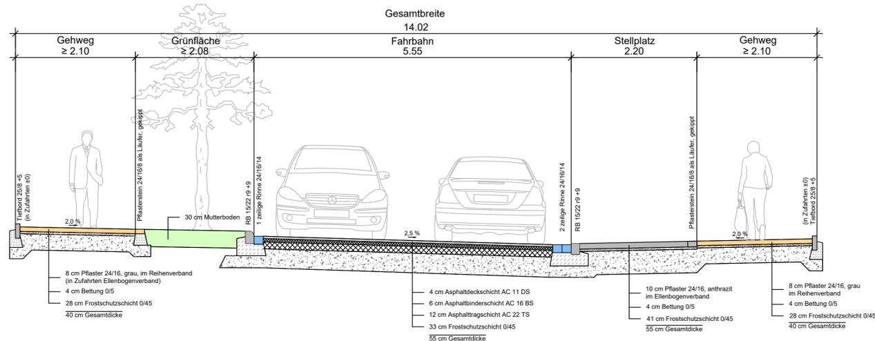
Deckenaufbau Gehweg M. 1:10
