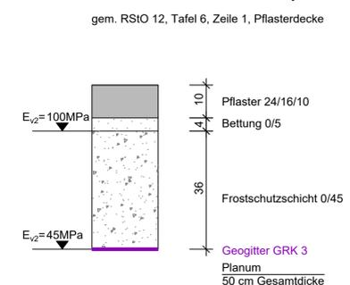
Deckenaufbau Gehweg M. 1:10
