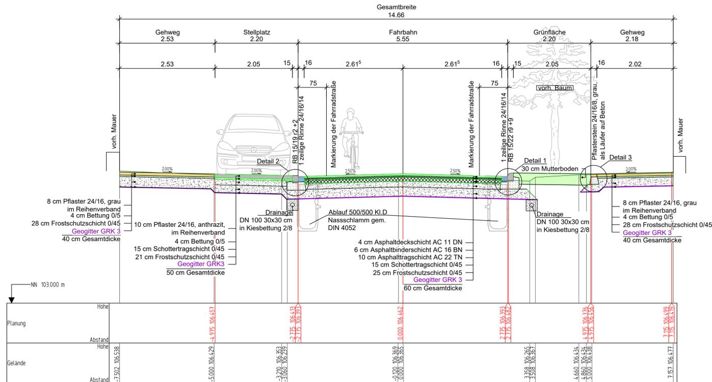
Deckenaufbau Fahrbahn M. 1:10
