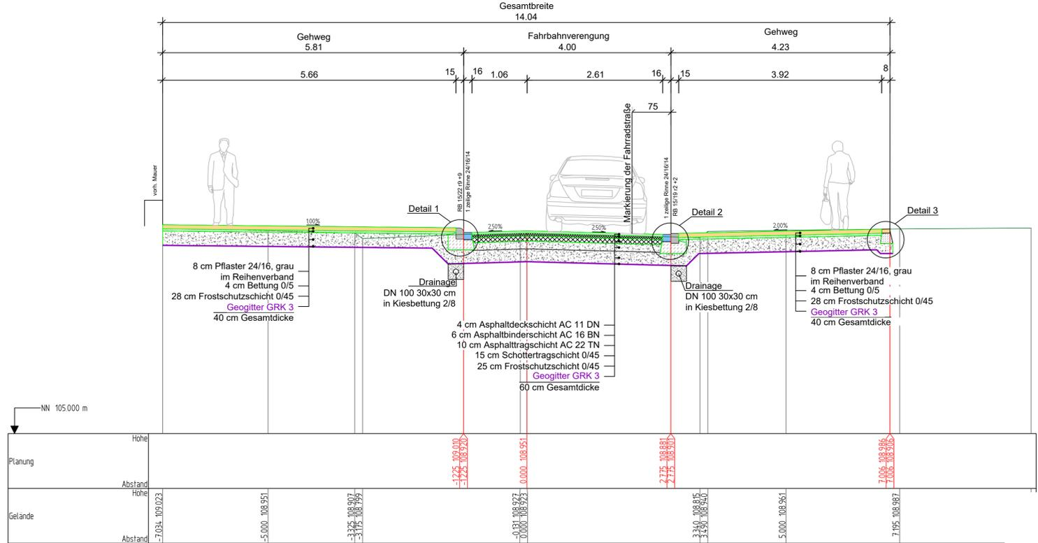
Deckenaufbau Fahrbahn M. 1:10
