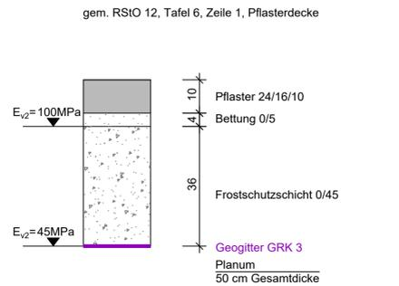
Deckenaufbau Gehweg M. 1:10
