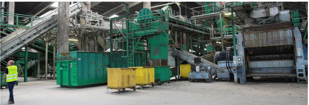
Abbildung 11: Nachzerkleinerer in der MBA-Anlage
