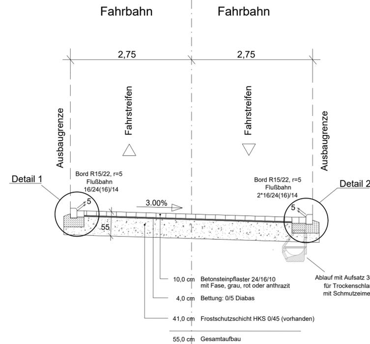
Deckenaufbau Fahrbahn, M. 1:10
