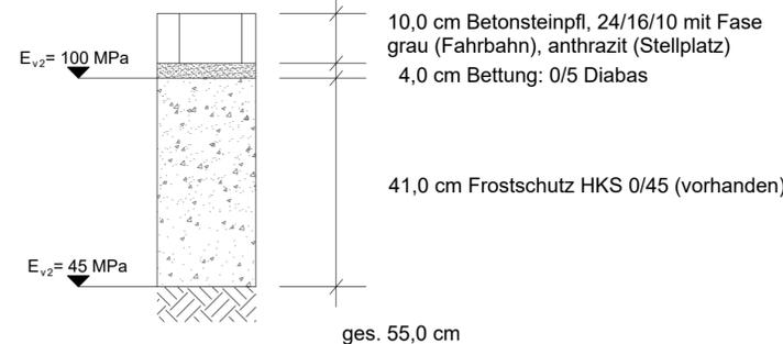
Deckenaufbau Fahrbahn, M. 1:10
