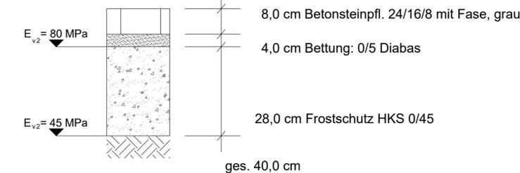
Deckenaufbau Gehweg, M. 1:10
