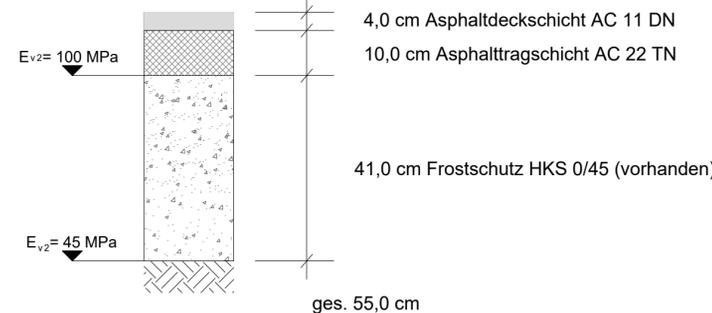
Deckenaufbau Gehweg, M. 1:10
