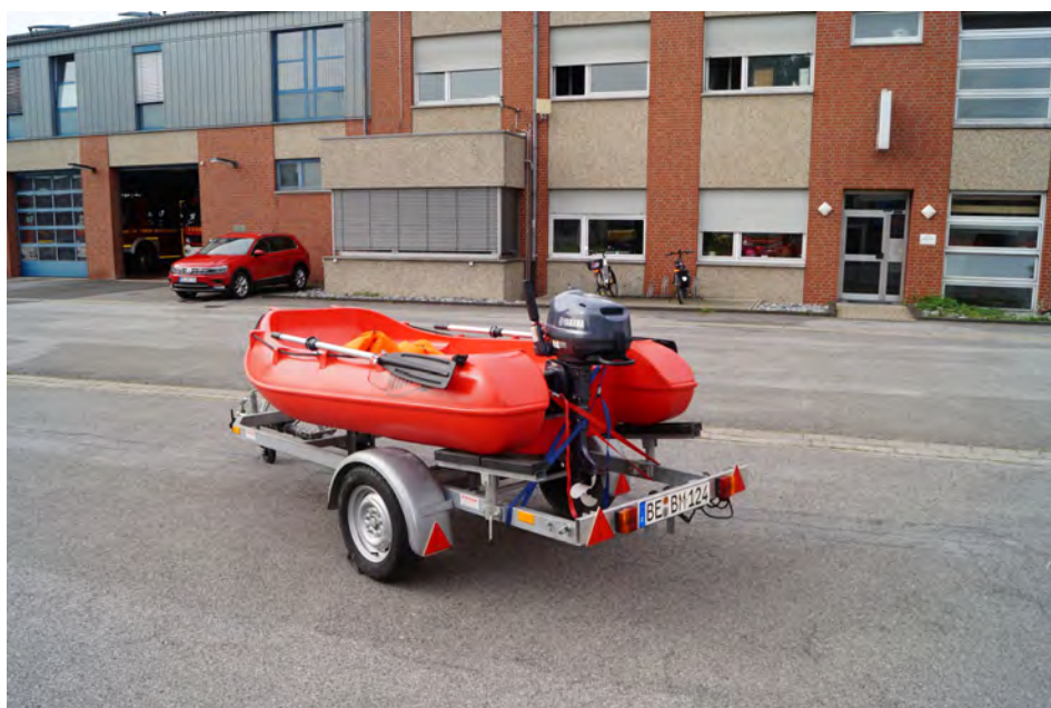
Abb. 7.5-10: Fw Beckum: Rettungsboot ohne Propellerschutz auf Anhänger (Foto: Beelmann)
