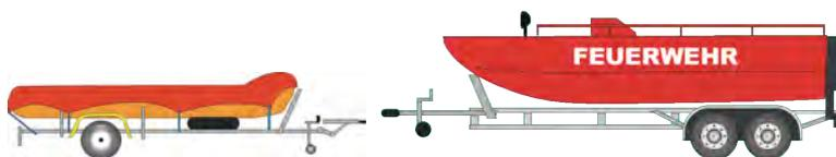
Anhänger zum Transport von Booten für die Wasserrettung. Dies können Schlauchboote oder auch Boote mit einem Rumpf aus festem Material wie GFK sein.
