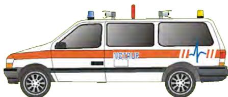
Pkw (Kombi) als Fahrzeug zur Zubringung des Notarztes, der im Rendezvous-Verfahren an der Einsatzstelle den RTW ergänzt. Das Fahrzeug ist mit der vollständigen Ausrüstung für die Notfallmedizin ausgestattet, jedoch nicht zum Transport von Patienten einsetzbar.
