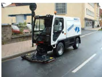
Fahrzeug zur Beseitigung von Öls Spuren auf Fahrbahnoberflächen. Es wird mit speziellen Rotordüsen ein Wassergemisch unter Hochdruck auf die zu reinigende Fläche aufgebracht. Im gleichen Arbeitsgang wird durch ein Zweikammer-Vakuumsystem der abgelöste Schmutz mit dem Wasser abgesaugt. Auch Wände und schwer zugängliche Stellen können mit einer Reinigungslanze schnell gesäubert werden.
