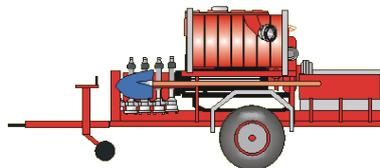
Auf dem Anhänger ist ein Behälter mit Löschpulver inkl. Druckmittel und Angriffsschläuchen zur Bereitstellung von Löschpulver montiert.
