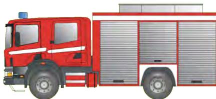
Fahrzeug mit feuerwehrtechnischer Beladung und ggf. Wasservorrat. Es wird primär zur Brandbekämpfung eingesetzt, kann aber auch zur Technischen Hilfeleistung herangezogen werden. Mitgeführte tragbare Leitern (Steckleiter und Schiebleiter) ermöglichen die Menschenrettung aus Gebäuden bis zur mittleren Höhe. Löschgruppenfahrzeuge haben eine eingebaute Feuerlöschkreiselpumpe oder führen eine oder mehrere Tragkraftspritzen mit sich.
