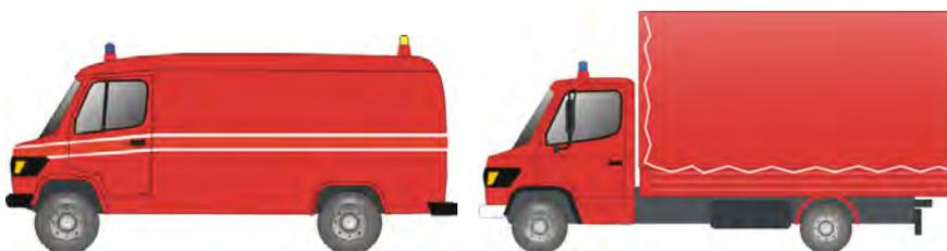
Fahrzeug für den Materialtransport, häufig in Ausführung als Kleintransporter mit Pritsche (ggf. mit Plane und Spriegel) oder als geschlossener Kleinbus.
