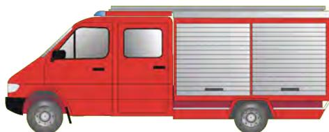
Fahrzeug mit feuerwehrtechnischer Beladung für eine Gruppe. Ein TSF wird vornehmlich zur Bekämpfung kleinerer Brände eingesetzt. Als TSF-T (alte Norm) war es vorgesehen für eine Truppbesetzung, als TSF-W (aktuelle Norm) ist es wasserführend.
