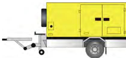
Anhänger mit einem Stromerzeuger zur Versorgung von Einsatzstellen mit elektrischer Energie.
