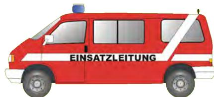
Fahrzeuge der Einsatzleitung, die insbesondere mit Informations- und Kommunikationsmitteln (Alarm- und Einsatzpläne, Gefahrstoff-Nachschlagewerke, Telefon, erweiterter Funkausrüstung, ggf. Fax, PC mit Datenbanken) ausgerüstet sind. Typen der ELW werden nach Norm in Abhängigkeit von der Größe gekennzeichnet mit ELW 1 (Kleinbus, Transporter) bzw. ELW 2 (Lkw oder Abrollbehälter).
