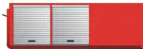
Abrollbehälter mit verschiedenen Löschmitteln (z. B. Schaummittel, Löschgase wie CO<sub>2</sub>, Löschpulver, Sand) für die Brandbekämpfung bei Metallbränden.
