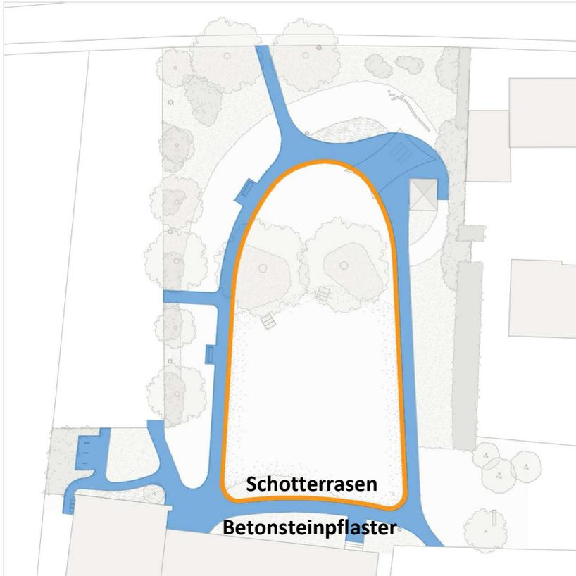
Für die befestigten Flächen kommt ein helles, sandfarbenes Betonsteinpflaster zum Einsatz (blau).
