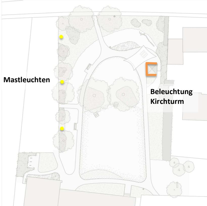
Die Mastleuchten entlang des Parkplatzes werden erneuert (gelb). Der Kirchturm wird durch eine nach unten gerichtete Beleuchtung betont (orange).
