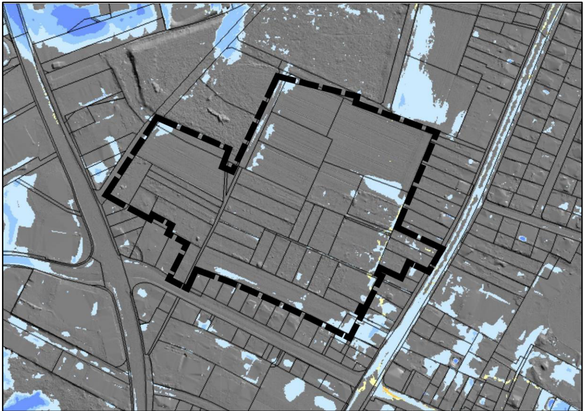
Abbildung 9: Starkregengefahrenkarte des Bundesamtes für Kartographie und Geodäsie (BKG), Wasserhöhe bei einem extremen Niederschlagsereignis im Bereich des Bebauungsplanes Nr. 74 „An der Steinbruchallee“
